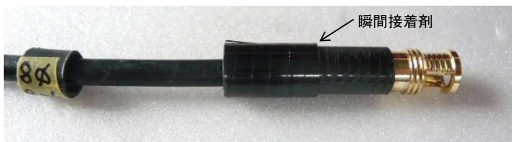
5、プラグが前後しないように抜け止めを後ろから差し込み瞬間で固定します。
